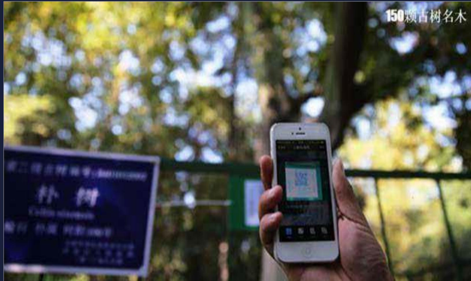
**古树名木物联网应用：**通过物联网采集古树名木状态信息，如倾斜，当斜角超过 $10^{\circ}$ 时发出告警，通知园林绿化部门及时采取救护措施。
