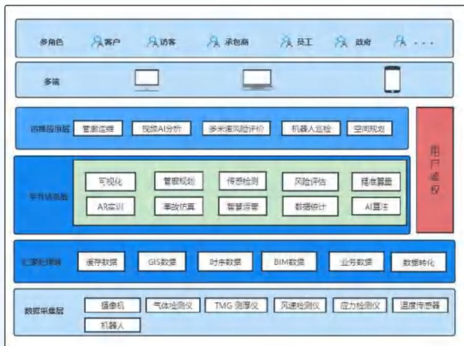
图1 上海化工区公共管廊服务运维系统总体架构
