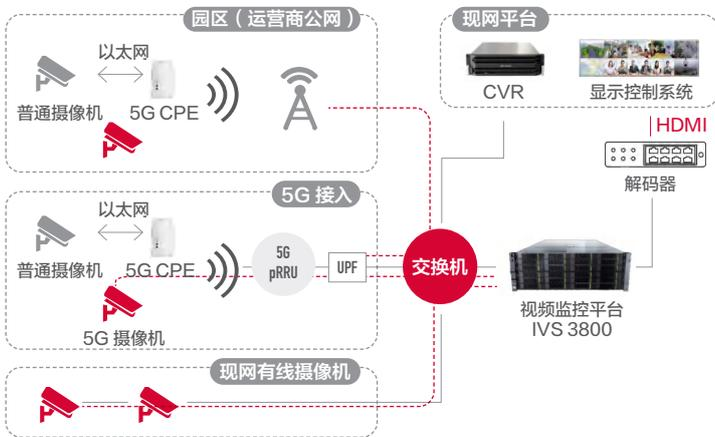
现有园区监控固定回传成本高：采用视频光端机+裸光纤或XPON+光猫方式，12芯光缆每公里平均8-10万元，其中挖沟成本3万元左右，节点扩展不灵活；PoE供电在线率低，维护成本高；现有4G上传带宽有限，难以支撑多路高清视频应用。
