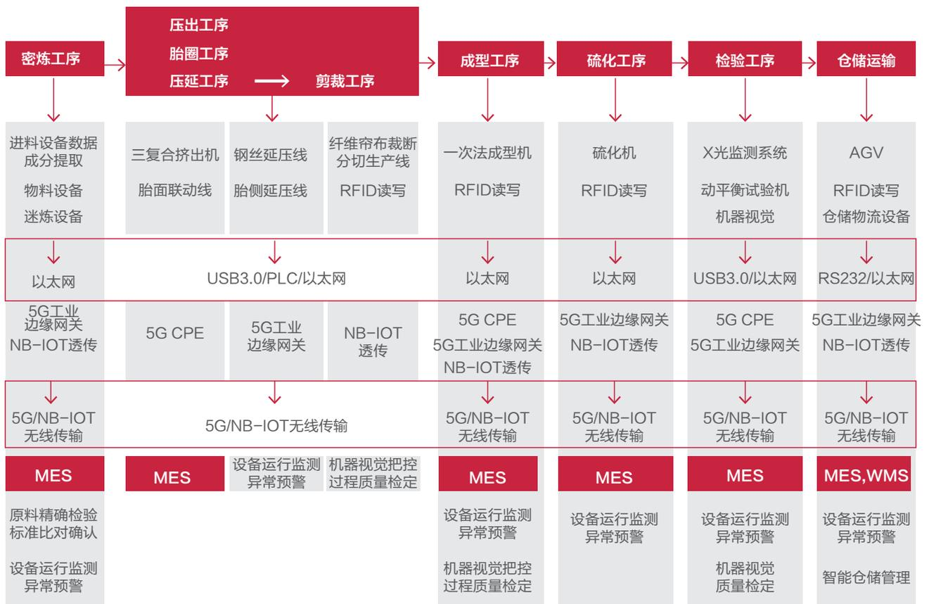
RFID 系统共计 50 套，贯穿于轮胎整条生产线，部署于各个生产流程，RFID 系统能够实时、追溯产品在各个流程环节生产进度与情况，通过 MES/MOM 系统进而调度管理 AGV 以及其他生产产线。
