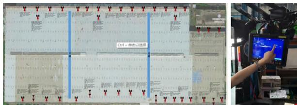
2 仓库内 AGV 路径：从注塑车间到车间内的仓库，从仓库到车间门口，共需 AGV11 台。原使用企业内的 WiFi 需认证，同时考虑隔离，当前针对每个项目均独立部署一套 WiFi 局域网，并不便于 AGV 设备大范围、跨区域调配。目前应用 5G 网络，支撑 AGV 到调度系统服务器的实时信息同步（小车任务下发指令，小车状态管控，信息反馈），使 AGV 小车全作业区域运行具备先决条件。
