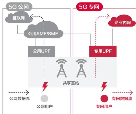
灵活定制，构建一张增强带宽、低时延、数据不出园的基础连接网络。用户面网元 UPF/MEC 私有化部署，无线基站根据客户需求灵活部署，为 AGV、RFID 系统提供部分物理独享的 5G 专用网络切片，不仅能够满足 AGV 低延时无缝衔接的同时保障生产制造流程环节不受公众网络系统影响，进一步提高少人化产线生产制造安全。
