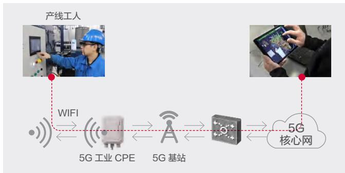
的工程师，工程师实时看到现场画面，可通过实时标注方式，协助指导问题快速解决。相关数据实时上传记录，工程师可实现 1 对多的支持。
