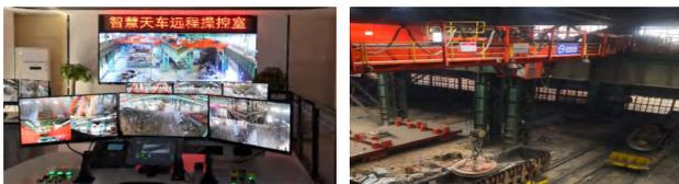
化自动装载运输。5G天车远程操控可解决工业Wi-Fi覆盖及容量不足、抗干扰能力差、光纤铺设困难、成本高、维护复杂等问题，同时极大改善了职工的工作环境，显著提高人工劳效。
